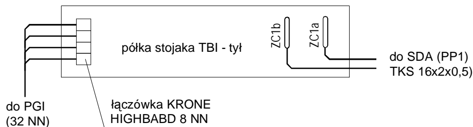
Rys. 3. Rozmieszczenie teletransmisyjnych barier iskrobezpiecznych TBI 2w stojaku TBI
